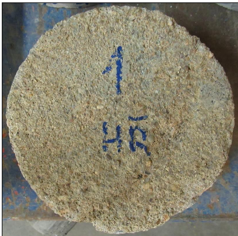
Foto 5: Pohled na líc vývrtnu CHRL1 před zkouškou
