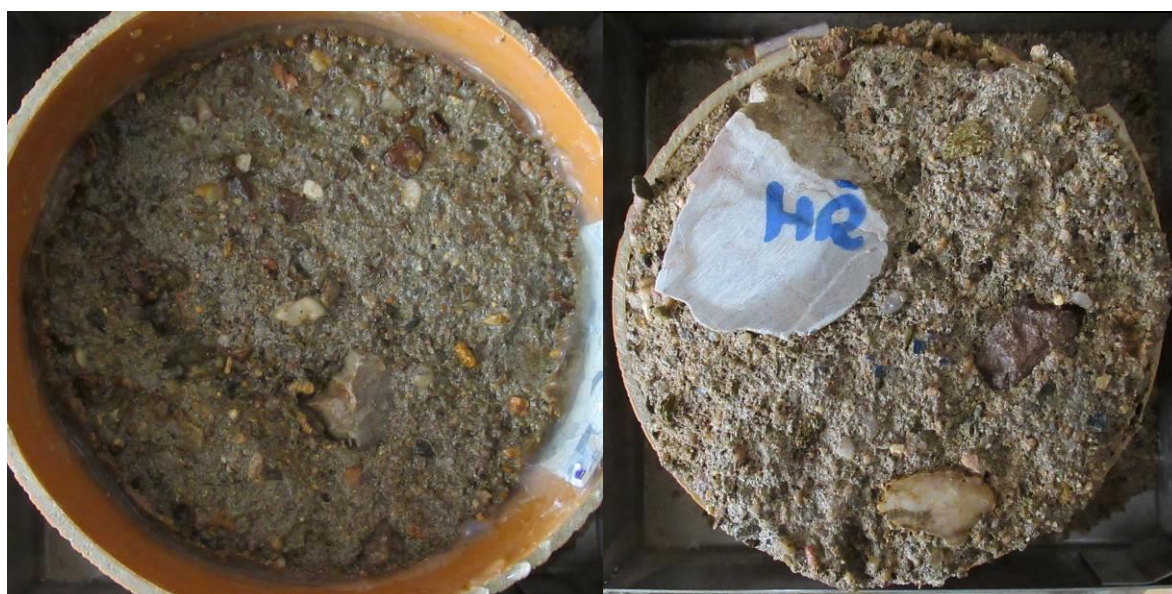
Foto 6: Pohled na líc a „dno“ vzorku CHRL1 – po CH.R.L. - metoda C – 50 cyklů
